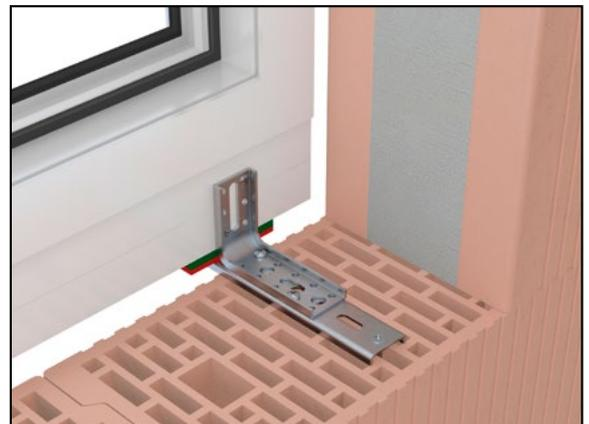
VBW-65x95x2,5 U-Profil, EL-Anker, V-Lochschiene
