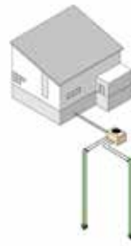
Sonda geotérmica vertical
