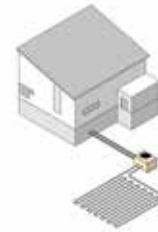
Colector geotérmico horizontal
