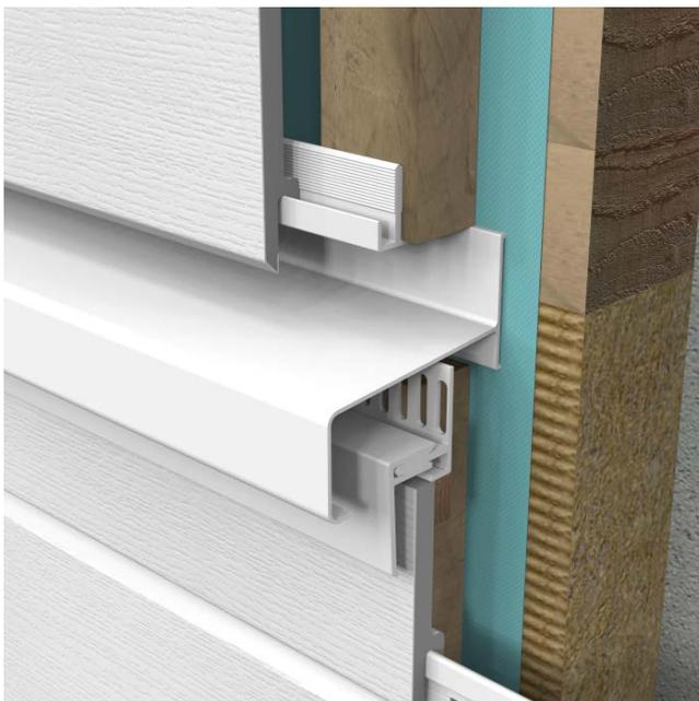
Si vous avez une façade de plus de **6m** de hauteur, une rupture horizontale doit être prévue pour faciliter la ventilation au-dessus et au-dessous de la rupture avec un rejet d'eau. (FCA3063).
