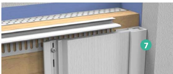
Si vous utilisez le bordure 'U' simple (7) il ne faut pas fixer le bas de la première lame, car la lame est soutenue par le profil.
