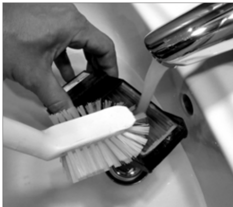
Reinigen des Wärmetauschers
