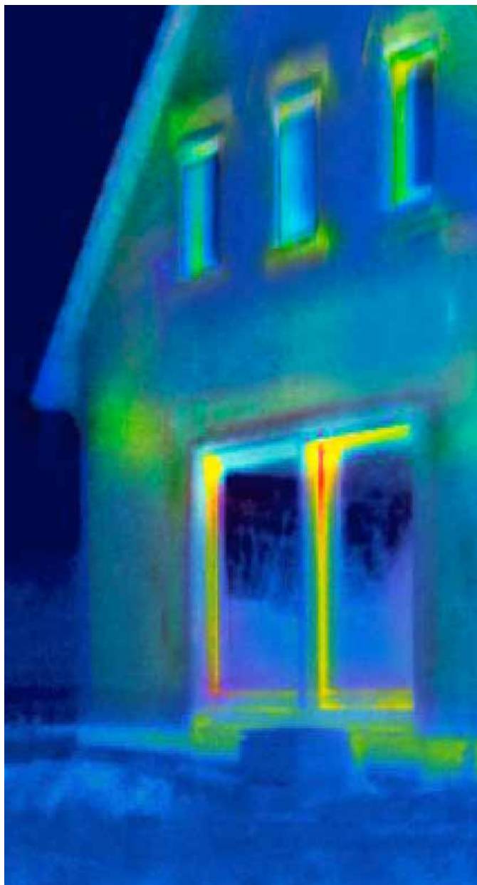
Voor renovatie: Hoogste warmteverlies is in rood afgebeeld.
