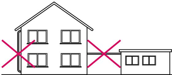
Fig. 29-7 La instalación al aire libre no está permitida y en el caso de las tuberías de agua solo se admite adoptando las medidas de protección correspondientes.
