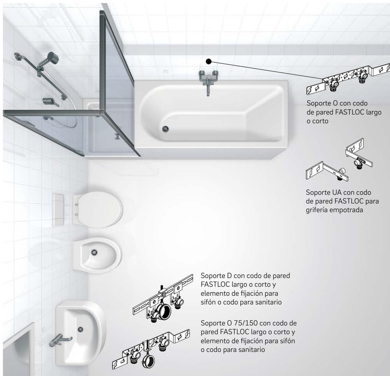
Fig. 04-3 Programa de soportes de montaje para baño y lavabo
