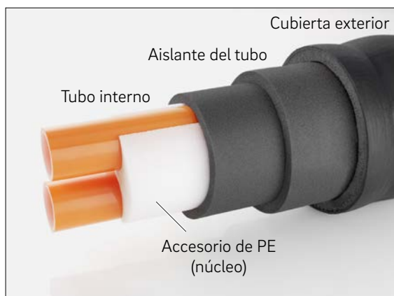
Fig. 03-14 Componentes principales del tubo RAUVITHERM
