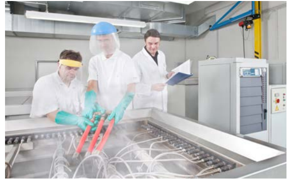
Fig. 06-20 En el ensayo de fatiga se determina la resistencia a la temperatura y a la presión de los tubos
