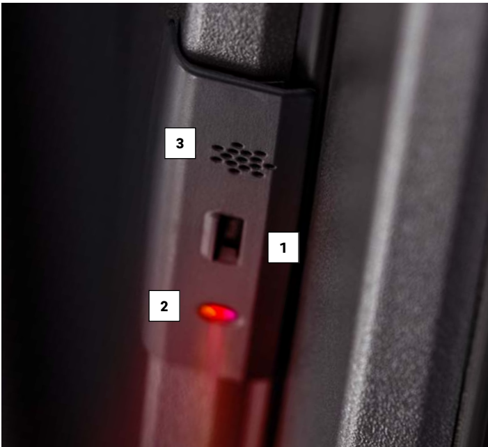
1 Senzorul de mișcare 2 LED 3 Emitătorul de semnale
