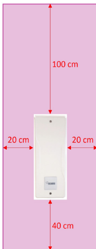
Unterputz-Master Controller Vorderansicht (vertikale Montage)
