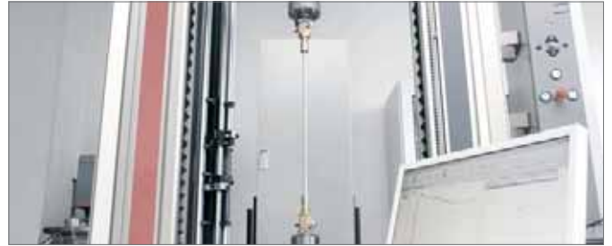
Fig. 3-3 Modalidad de desarrollo de una prueba de tracción
