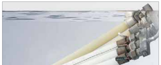
Fig. 3-4 Tubos expuestos a la prueba de duración (bajo presión en agua)
