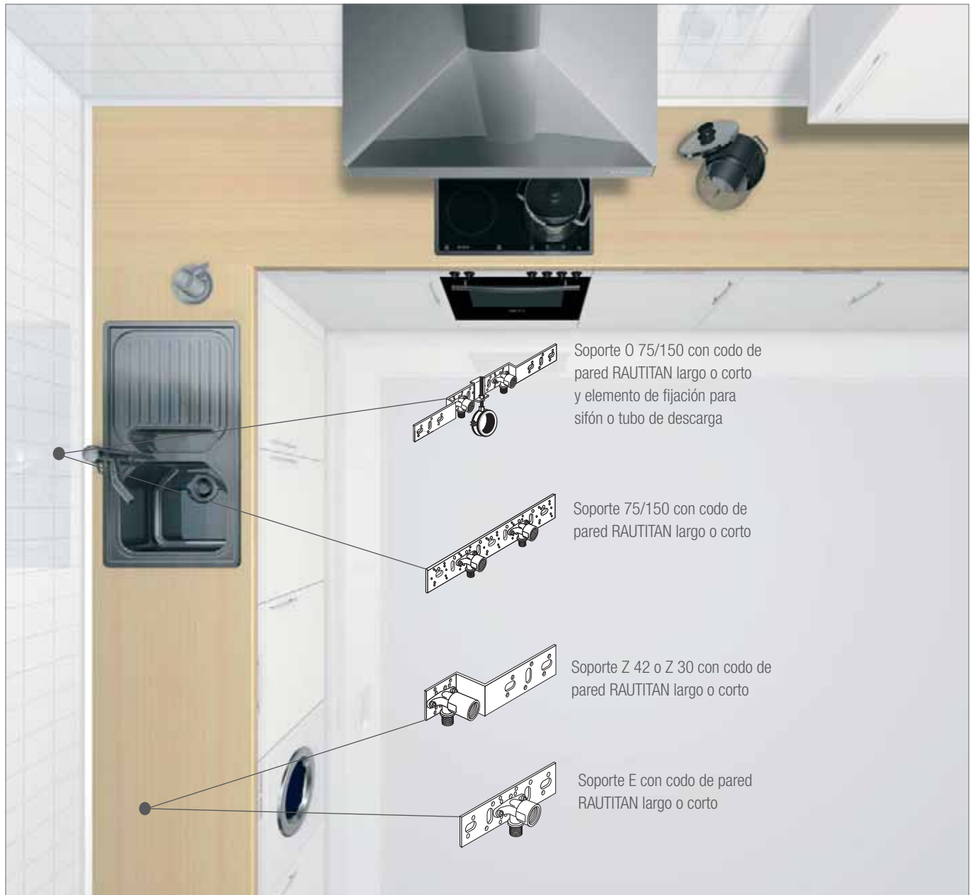
Fig. 5-7 Programa de elementos de fijación en cocina
