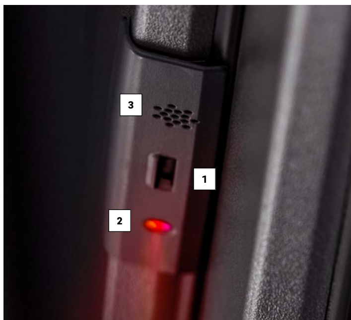
1 Detector de movimiento 2 LED 3 Generador de tono de alarma
