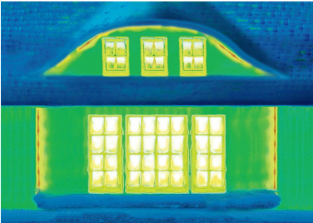
*Nach der Renovierung: minimierte Energieverluste mit Fenstern aus NORDIC DESIGN PLUS Profilen.*
